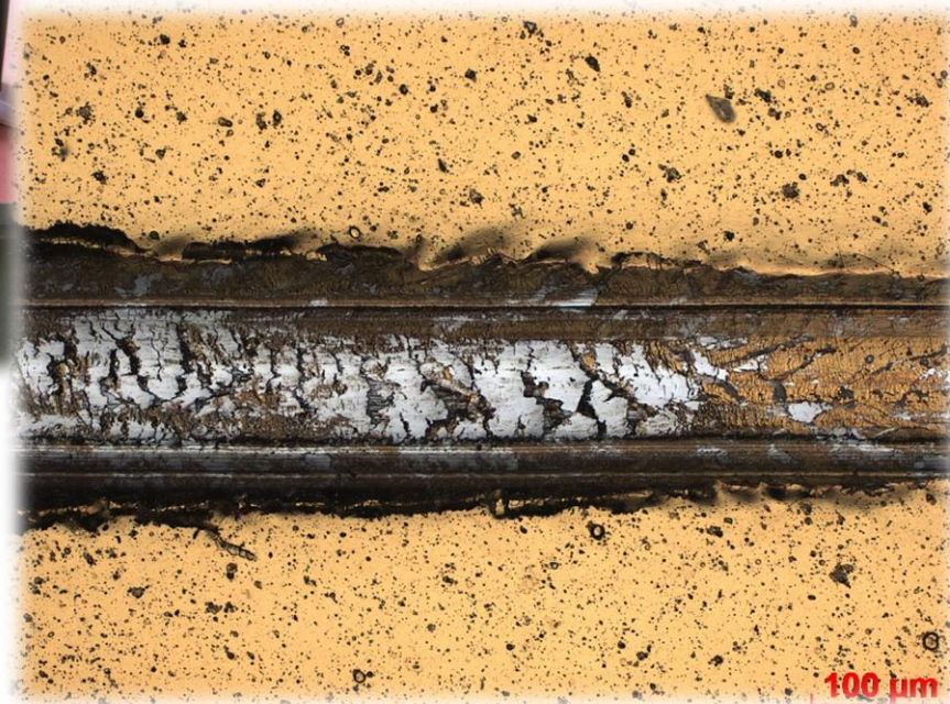
Detail vrypu po Scratch testu
